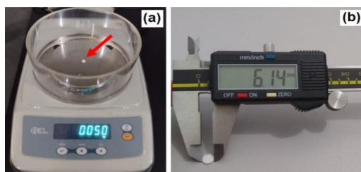
Figura 3.2 - Discos de quartzo-teflon: (a) pesagem dos discos e (b) aferição do diâmetro
