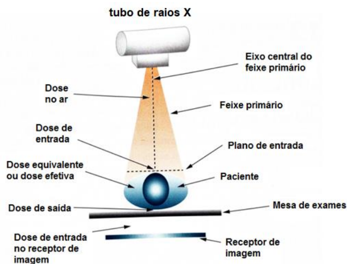
Figura 2.12– Conceitos usuais para dosimetria de raios X
