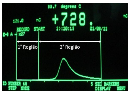
Figura 3.8 – Representação da curva TL para os discos de quartzo-teflon na região de leitura entre 200 e 350°C (tela da leitora TL Victoreen 2800M)
